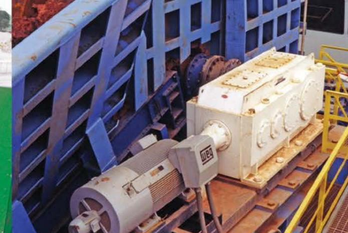
D7 Alimentador de Placas con accionamiento electro-mecánico
