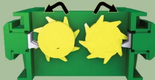
En los Sizers secundarios y terciarios, se puede utilizar el giro hacia el exterior con determinados materiales para producir productos más pequeños que con el giro hacia el interior.
