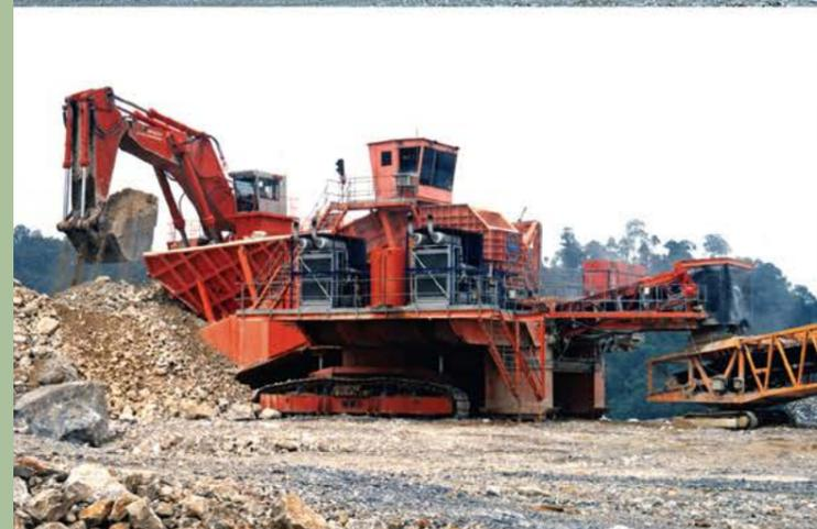
Completamente Móvil, Montado sobre Orugas | 1300 Series Sizer | D7 Apron Plate Feeder
