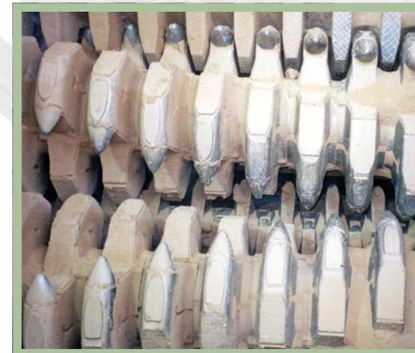
El diseño del rotor con dientes entrelazados permite que el material de menor tamaño fluya libremente y pase por los espacios que cambian constantemente, que son generados por los ejes que giran a una velocidad relativamente baja.
