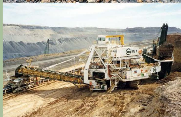
Estación Móvil de Sizer con Mesa de Giro | Chancador de la Serie 1400 | Alimentador de Placas D9
