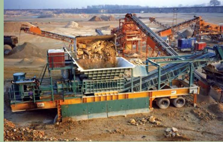
Remolque montado transportable | Sizer de la Serie 750
