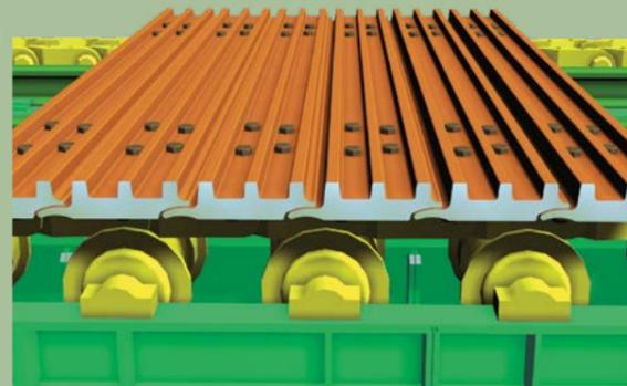
Es especialmente importante la eliminación de la energía de impacto. En principio, la fuerza del impacto se absorbe mediante las placas del transportador, que se deforman dentro de su límite elástico. Luego, los rieles de impacto transmiten las fuerzas que son disipadas en la estructura del bastidor principal.
