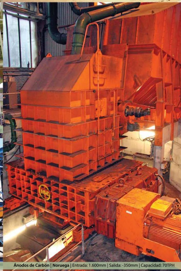
Anodos de Carbón | Noruega | Entrada: 1.600mm | Salida: -350mm | Capacidad: 70TPH
