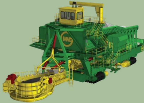
**MMD es la empresa innovadora de un nuevo producto que permite que se empareje la flexibilidad de la pala minera con la rentabilidad del transporte por correa sobre largas distancias. La Estación Móvil Sizer con Mesa de Giro de 9.000 Toneladas Métricas por Hora, constituye una nueva solución de ingeniería rentable, que permite que los procesos de excavación, trituración y transporte por correa se produzcan simultáneamente a lo largo del frente de la mina, avanzando según vaya progresando.**
