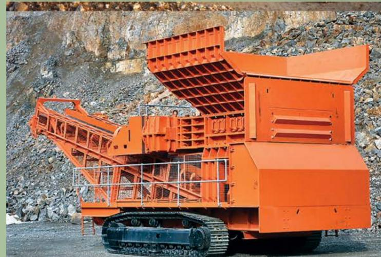
Completamente Móvil, Montado sobre Orugas | Sizer de la Serie 750
