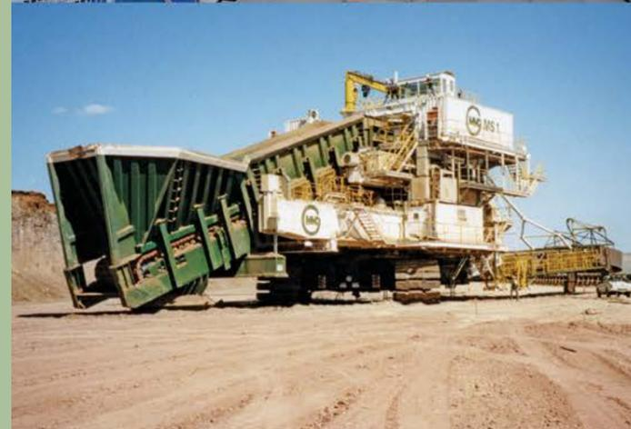
D9 Alimentador de Placas que forma parte de la Estación Móvil de Sizer con Mesa de Giro
