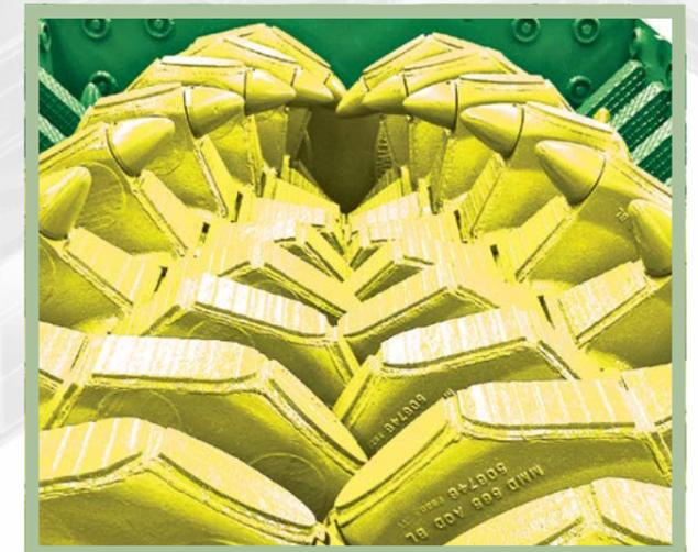
El sistema helicoidal de dientes de apertura profunda transporta el material de mayor tamaño hasta un extremo de la máquina, ayudando a extender la alimentación a través de la longitud total de los rotores. Se puede emplear dicha característica también para rechazar material de sobre tamaño de la máquina.
