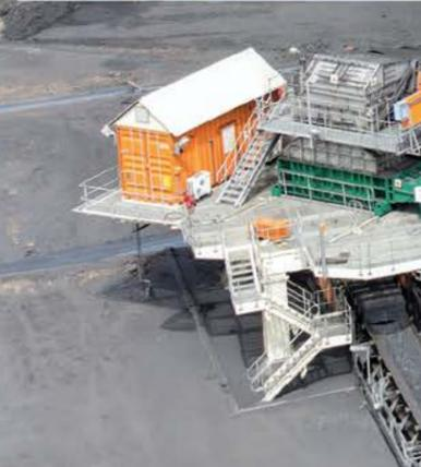
Estación Sizer Semi Móvil con una plataforma para camión / Reubicada por el Transportador MMD Atlas 500T (recuadro)
