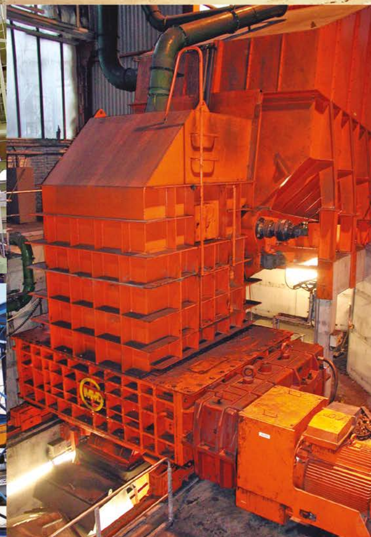
Karbonado | Norwegia | Nadawa: 1600mm | Produkt końcowy: -350mm | Wydajność: 70 t/godz
