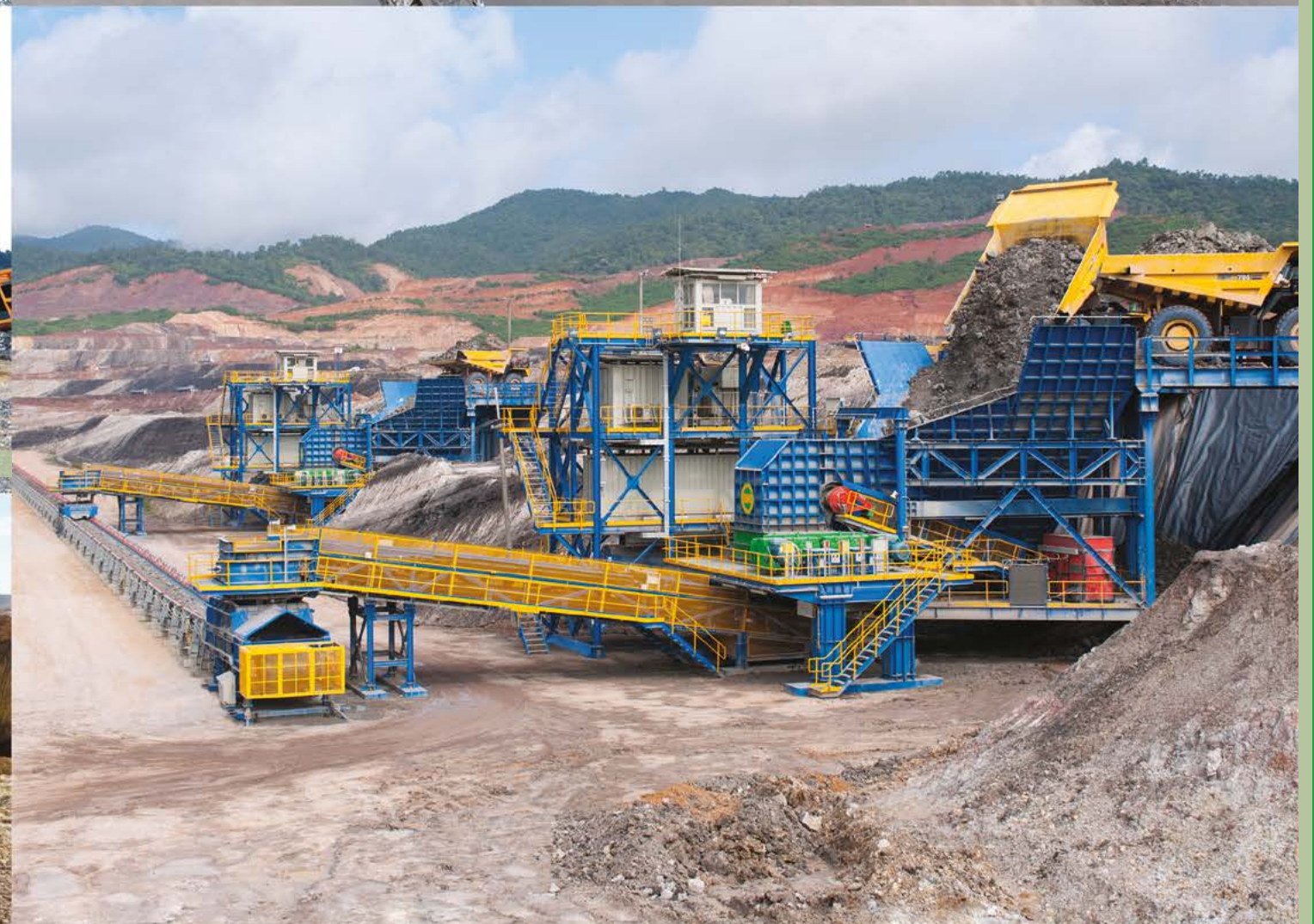
Sizer serii 1150 | Podajnik płytowy D7 | Częściowo mobilna instalacja rozdrabniania z podwójnym mostkiem
