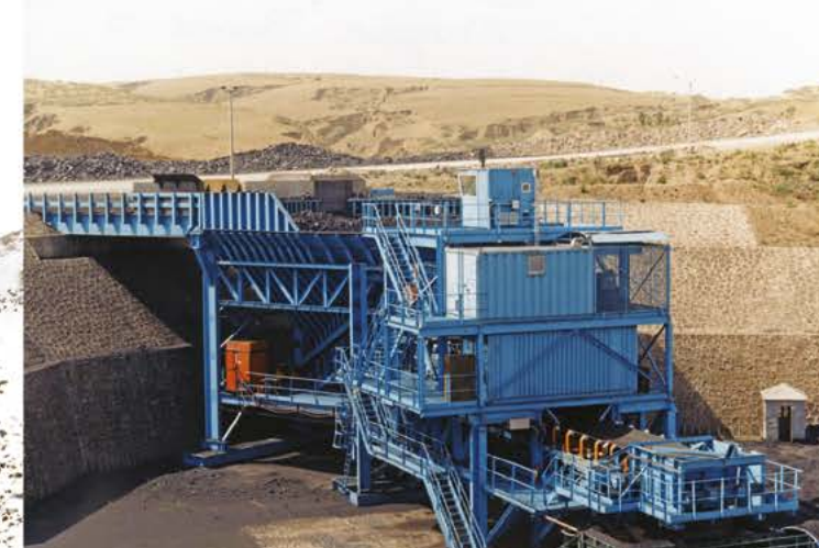
Węgiel brunatny | Chiny | Nadawa: 1800mm | Produkt końcowy: -300mm | Wydajność: 2500 t/godz
