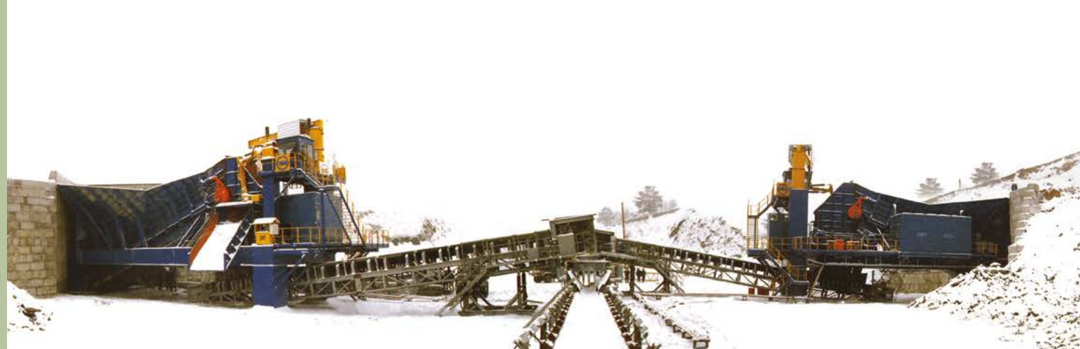
Nadkład | Rosja | Nadawa: 1200mm | Produkt końcowy: -350mm | Wydajność: 3500 t/godz
