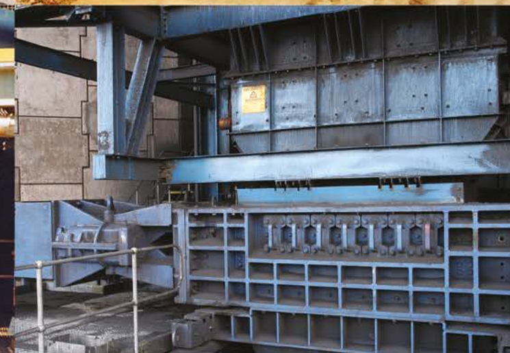
Węgiel | Republika Południowej Afryki | Nadawa: 1000mm | Produkt końcowy: -250mm | Wydajność: 2000 t/godz
