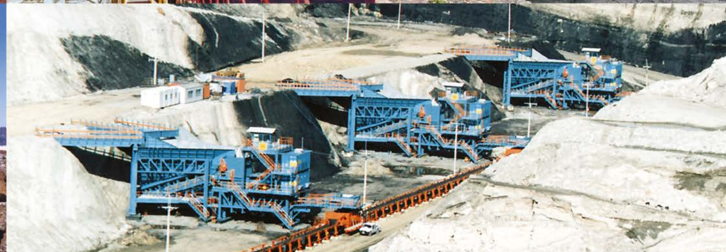
Nadkład | Tajlandia | Nadawa: 1500mm | Produkt końcowy: -300mm | Wydajność: 4500 t/godz
