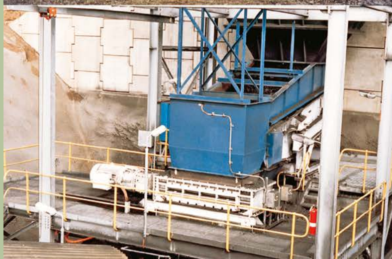
Węgiel | Australia | Nadawa: 400mm | Produkt końcowy: -150mm | Wydajność: 1300 t/godz
