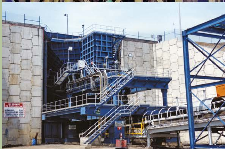
Węgiel | Kolumbia | Nadawa: 300mm | Produkt końcowy: -50mm | Wydajność: 1600 t/godz
