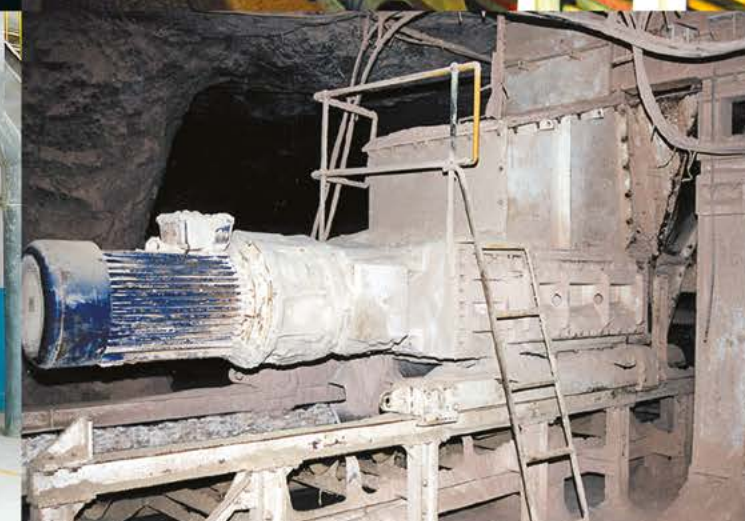
Gips | Wielka Brytania | Nadawa: 150mm | Produkt końcowy: -40mm | Wydajność: 300 t/godz
