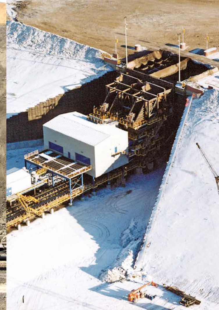
Piaski bitumiczne | Kanada | Nadawa: 3000mm | Produkt końcowy: -400mm | Wydajność: 8000 t/godz
