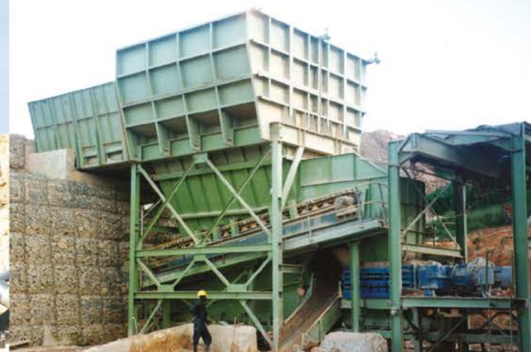
Kwarcyt | Ghana | Nadawa: 500mm | Produkt końcowy: -100mm | Wydajność: 300 t/godz
