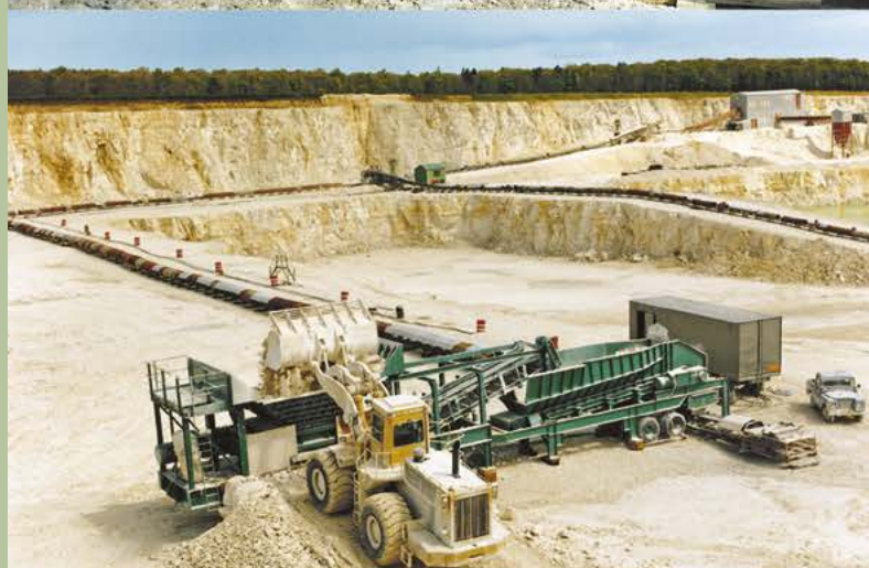
Kreda | Wielka Brytania | Nadawa: 500mm | Produkt końcowy: -300mm | Wydajność: 600 t/godz
