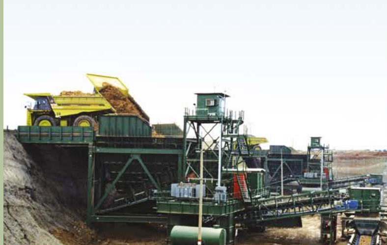
Nadkład | Tajlandia | Nadawa: 1200mm | Produkt końcowy: -400mm | Wydajność: 6500 t/godz
