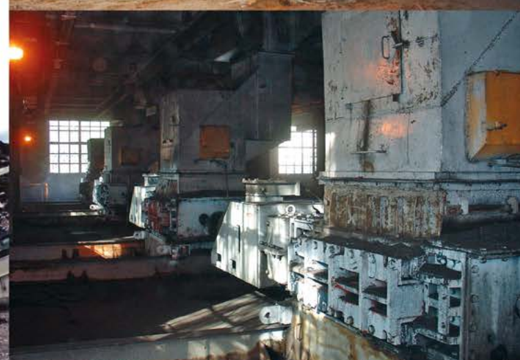
Węgiel | Chiny | Nadawa: 500mm | Produkt końcowy: -50mm | Wydajność: 300 t/godz
