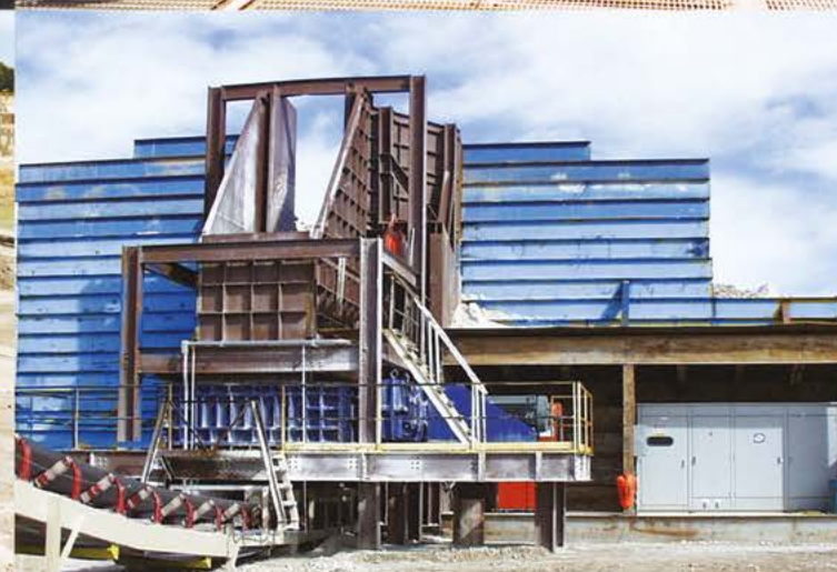
Gips | USA | Nadawa: ROM | Produkt końcowy: -250mm | Wydajność: 1000 t/godz
