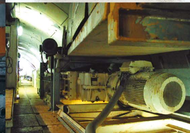
Glina / Wapień | Grecja | Nadawa: 350mm | Produkt końcowy: -200mm | Wydajność: 650 t/godz
