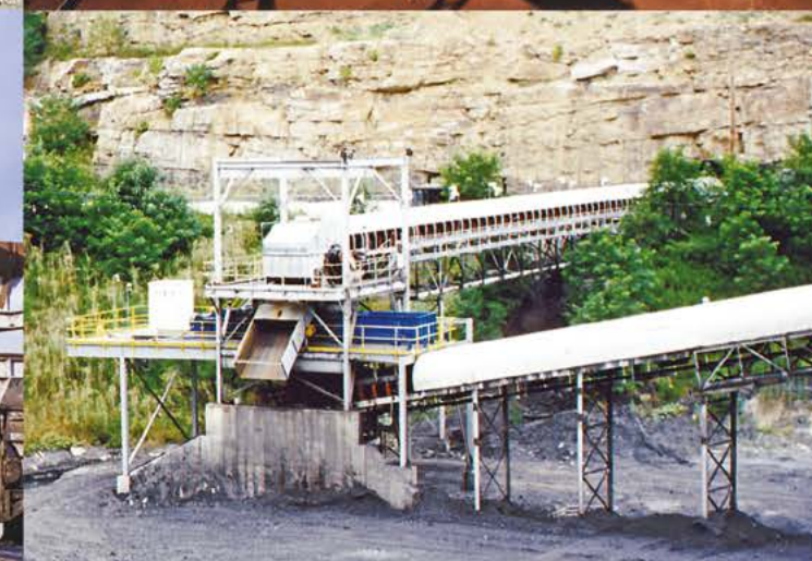
Węgiel | USA | Nadawa: ROM | Produkt końcowy: -200mm | Wydajność: 5000 t/godz
