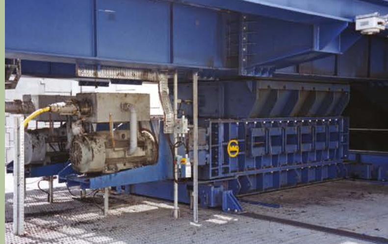
Węgiel | Kolumbia | Nadawa: 300mm | Produkt końcowy: -50mm | Wydajność: 1600 t/godz
