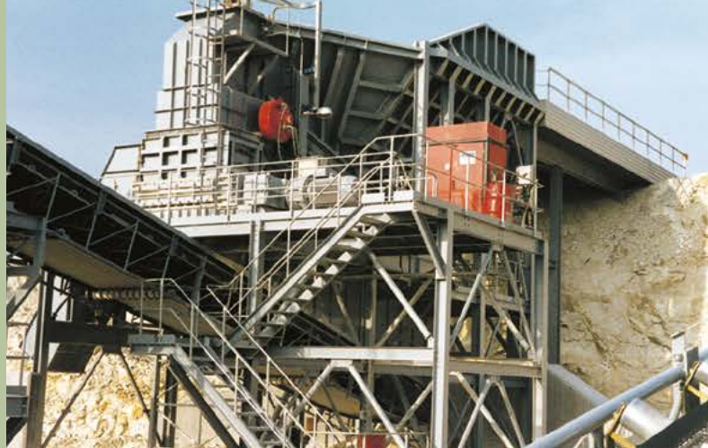
Wapień | Dania | Nadawa: 800mm | Produkt końcowy: -50mm | Wydajność: 450 t/godz
