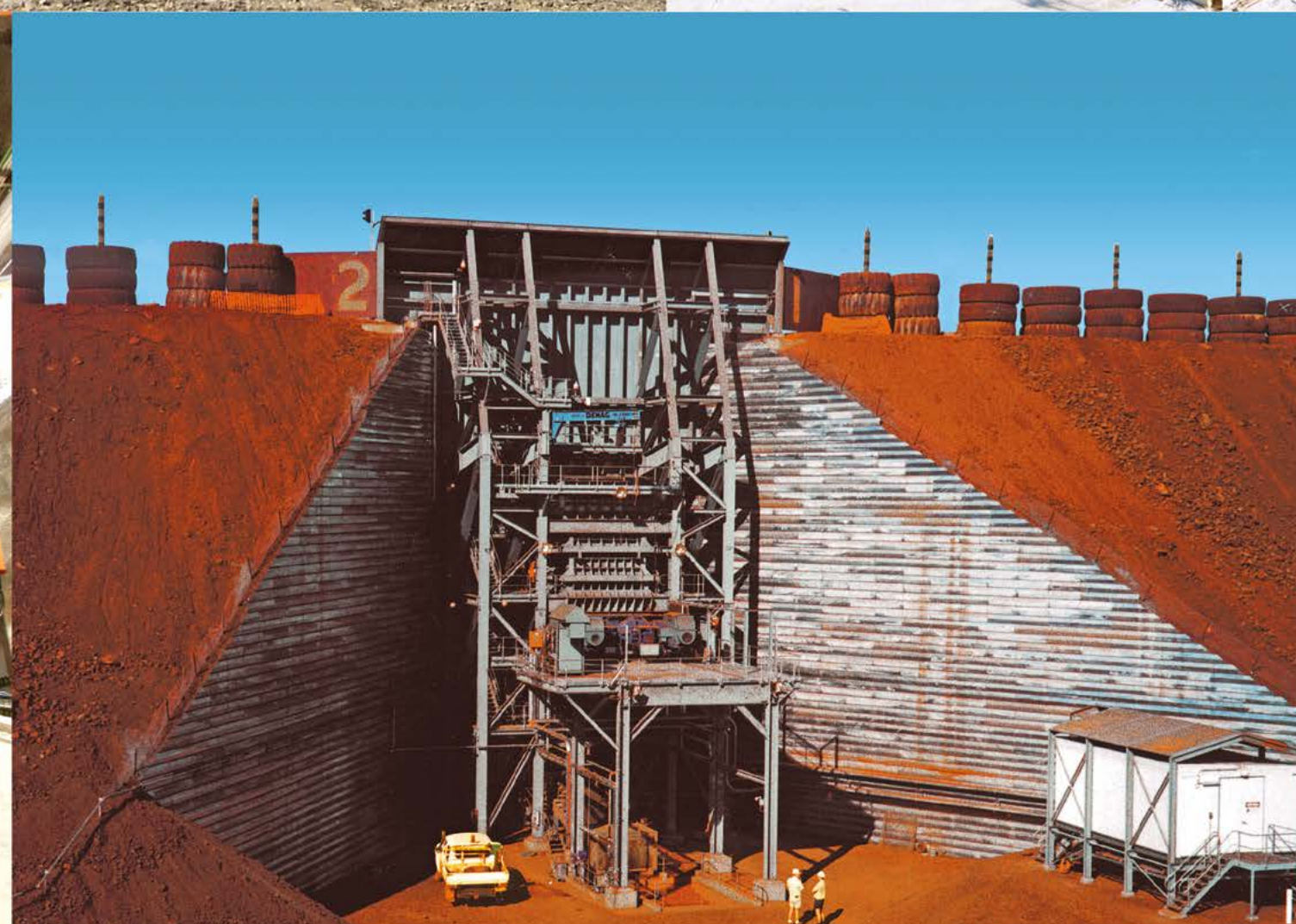
Ruda żelaza | Australia | Nadawa: 2500mm | Produkt końcowy: -250mm | Wydajność: 6000 t/godz
