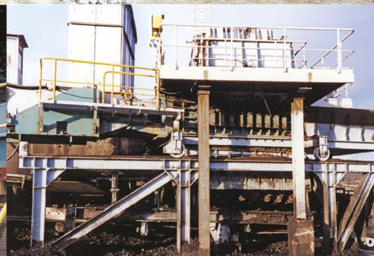
Węgiel brunatny | Hiszpania | Nadawa: 800mm | Produkt końcowy: -180mm | Wydajność: 2500 t/godz
