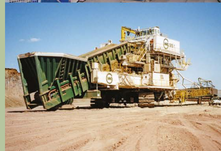
Podajnik płytowy D9, stanowiący część mobilnej obrotowej instalacji kruszenia
