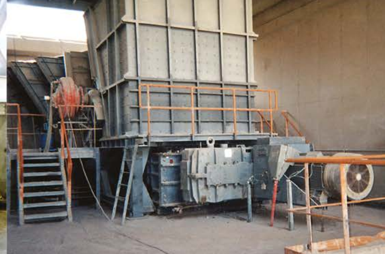
Wapień | Liban | Nadawa: 800mm | Produkt końcowy: -300mm | Wydajność: 1500 t/godz
