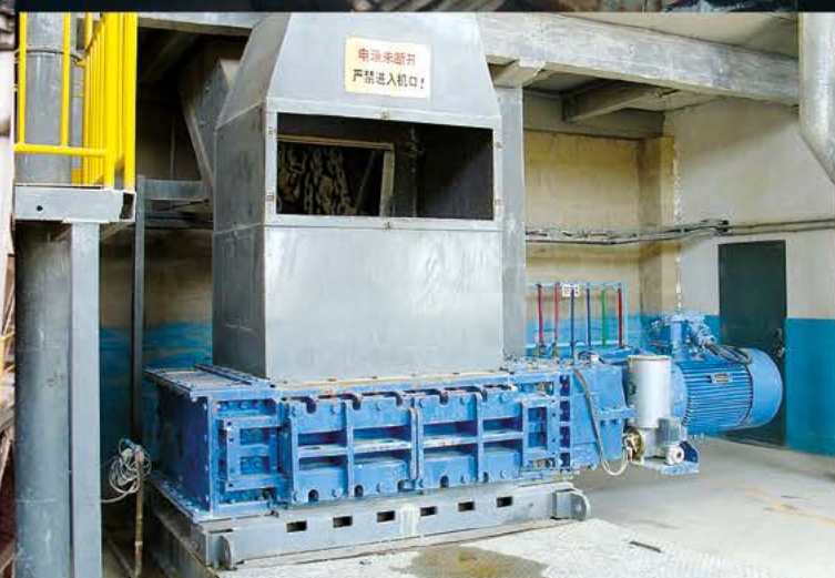
Wapień | Chiny | Nadawa: 300mm | Produkt końcowy: -80mm | Wydajność: 250 t/godz
