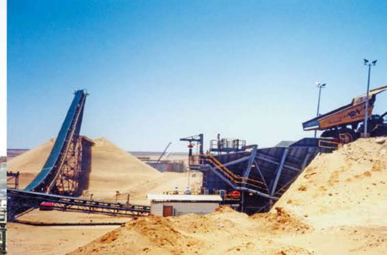
Piaski bitumiczne | Republika Południowej Afryki | Nadawa: 1500mm | Produkt końcowy: -300mm | Wydajność: 1500TPH
