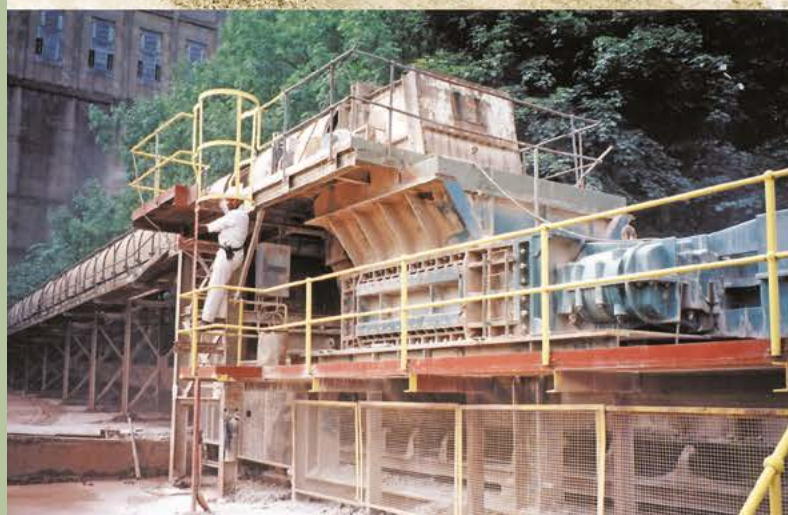
Wapień / Gлина | Wielka Brytania | Nadawa: 350mm | Produkt końcowy: -100mm | Wydajność: 1000 t/godz
