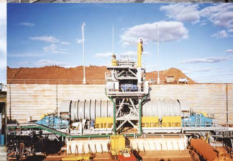
Ruda żelaza | Australia | Nadawa: 1200mm | Produkt końcowy: -250mm | Wydajność: 1200 t/godz
