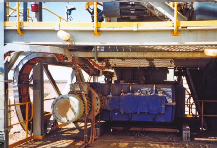
Ruda niklu | Australia | Nadawa: 800mm | Produkt końcowy: -200mm | Wydajność: 800 t/godz
