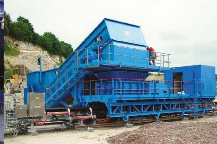
Kreda | Belgia | Nadawa: 800mm | Produkt końcowy: -250mm | Wydajność: 500 t/godz
