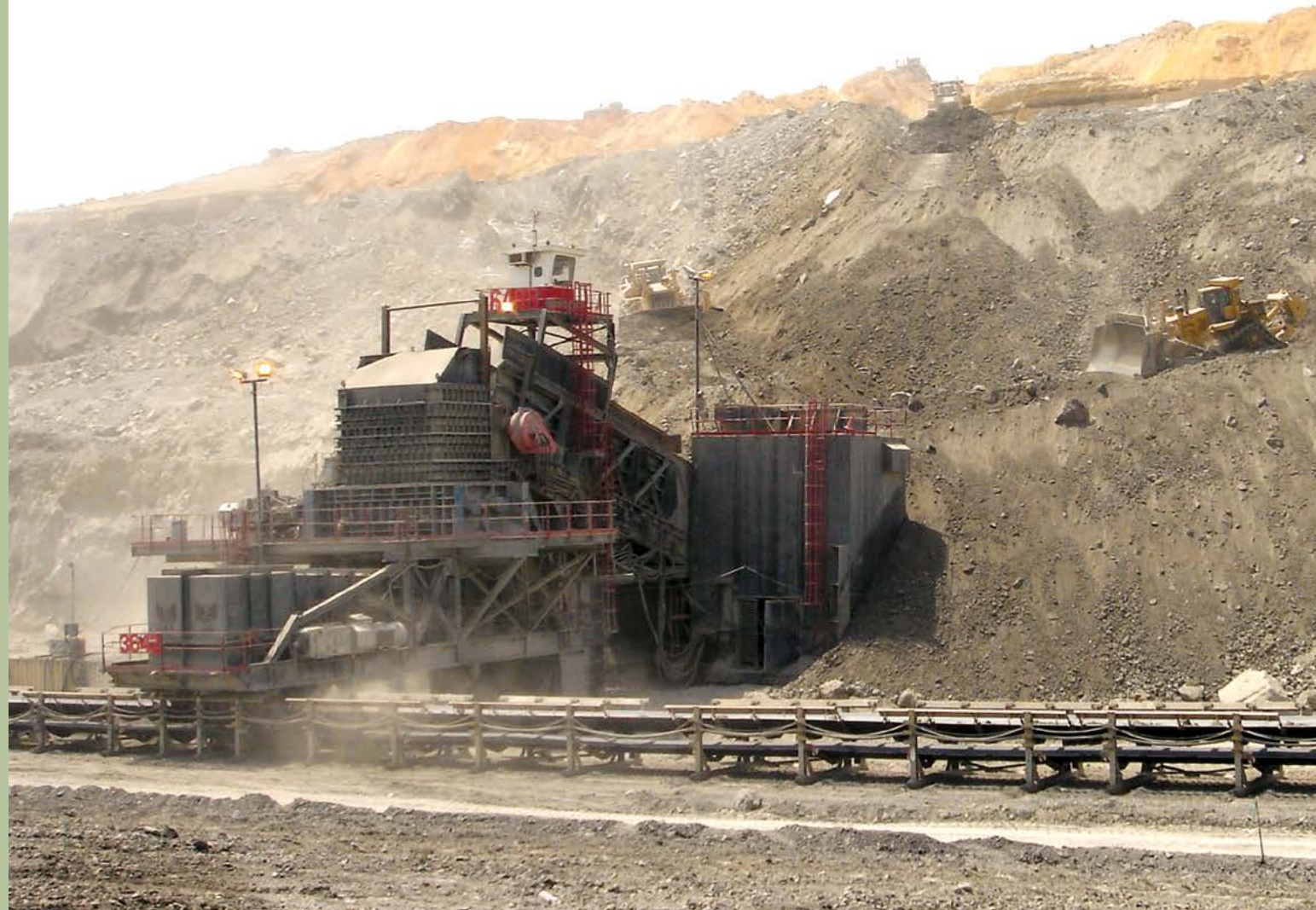
Nadkład | Kolumbia | Nadawa: ROM | Produkt końcowy: -450mm | Wydajność: 20000 t/godz
