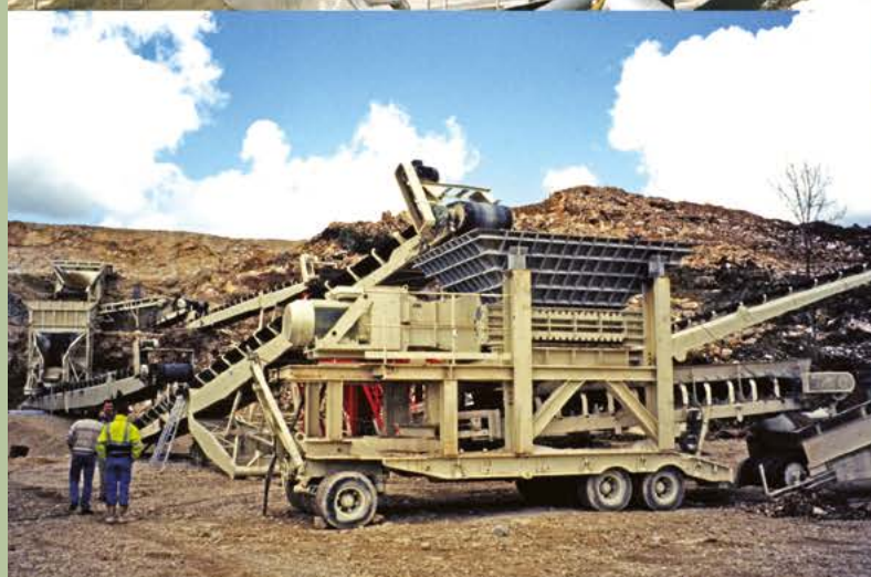
Kruszywa | Francja | Nadawa: 250mm | Produkt końcowy: -100mm | Wydajność: 600 t/godz
