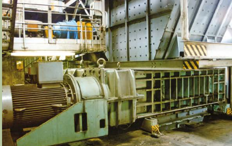
Węgiel | Republika Południowej Afryki | Nadawa: 1000mm | Produkt końcowy: -180mm | Wydajność: 900 t/godz
