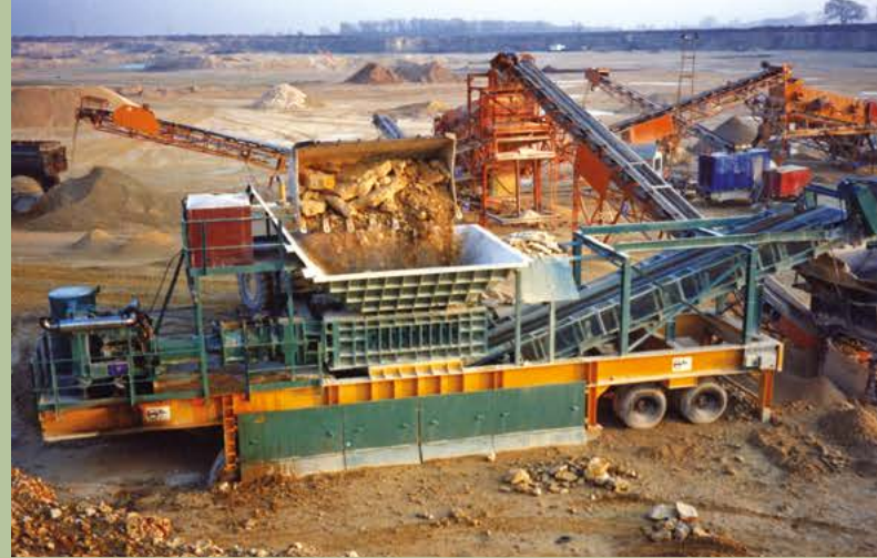
Sizer serii 750 | Przewoźny, na przyczepie kołowej
