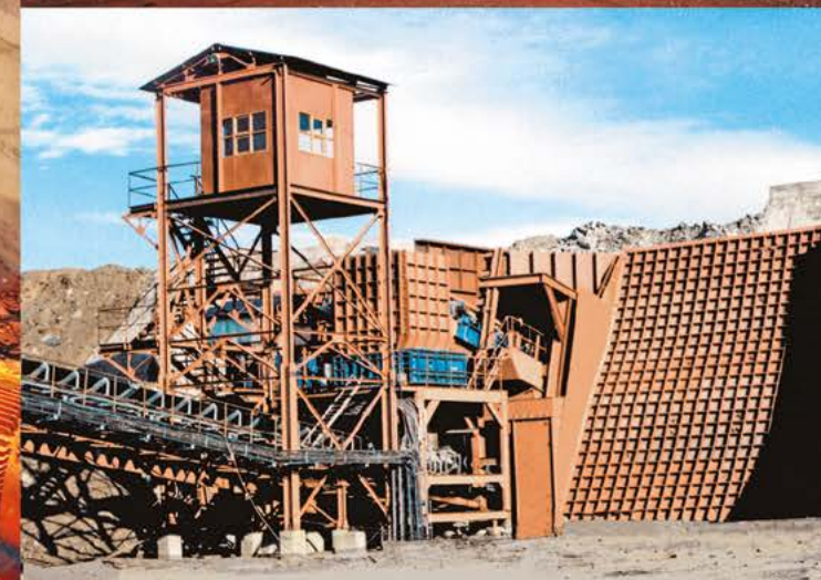
Wapień | Indie | Nadawa: 300mm | Produkt końcowy: -150mm | Wydajność: 700 t/godz
