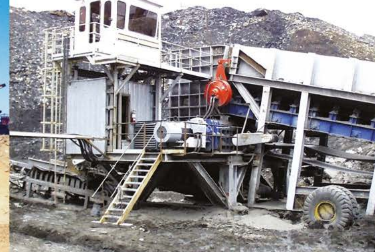
Nadkład | Kanada | Nadawa: 1500mm | Produkt końcowy: -250mm | Wydajność: 2000 t/godz
