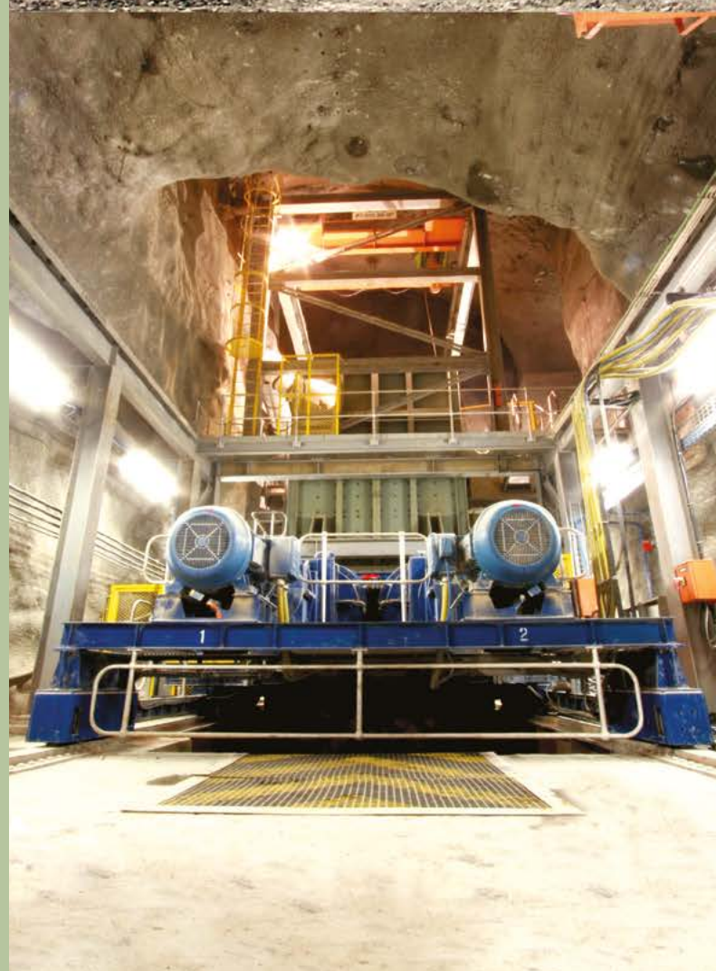
Kimberlit | Republika Południowej Afryki | Nadawa: 2000mm | Produkt końcowy: -300mm | Wydajność: 800 t/godz
