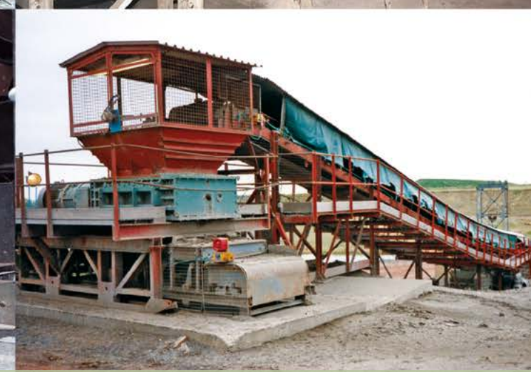
Glina | Wielka Brytania | Nadawa: 250mm | Produkt końcowy: -100mm | Wydajność: 600 t/godz
