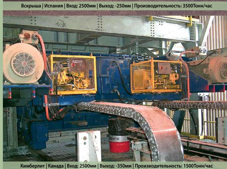
Кимберлит | Канада | Вход: 2500мм | Выход: -350мм | Производительность: 1500Тонн/час
