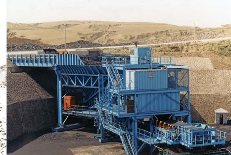
Лигнит | Китай | Вход: 1800мм | Выход: -300мм | Производительность: 2500Тонн/час
