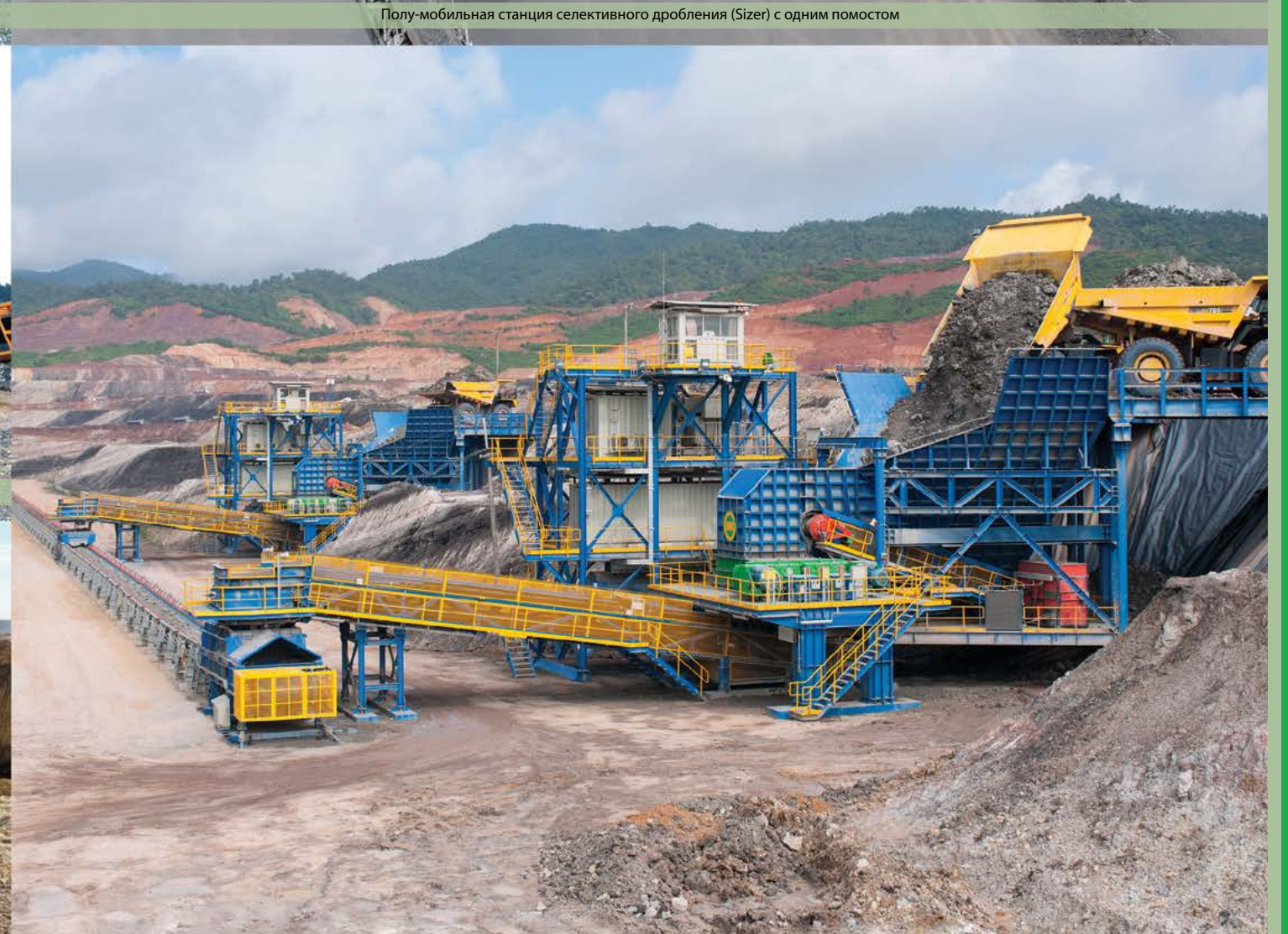
Полу-мобильная станция с двумя помостами | Дробилка селективного дробления (Sizer) серии 1150 | Пластинчатый питатель D7
