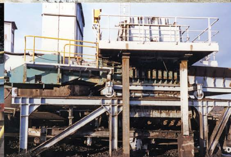
Лигнит | Испания | Вход: 800мм | Выход: -180мм | Производительность: 2500Тонн/час
