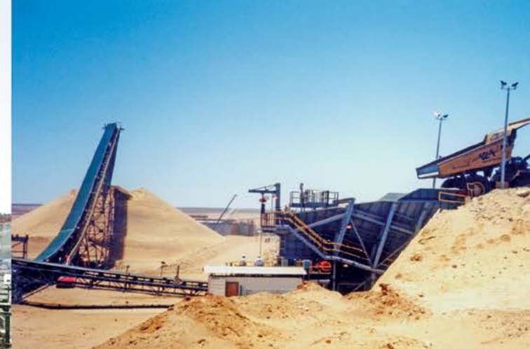
Минеральный песок | Южная Африка | Вход: 1500мм | Выход: -300мм | Производительность: 1500Тонн/час
