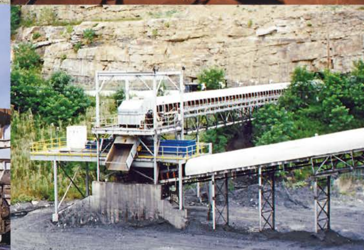
Уголь | USA | Вход: ROM | Выход: -200мм | Производительность: 5000Тонн/час
