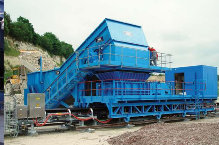
Мел | Бельгия | Вход: 800мм | Выход: -250мм | Производительность: 500Тонн/час
