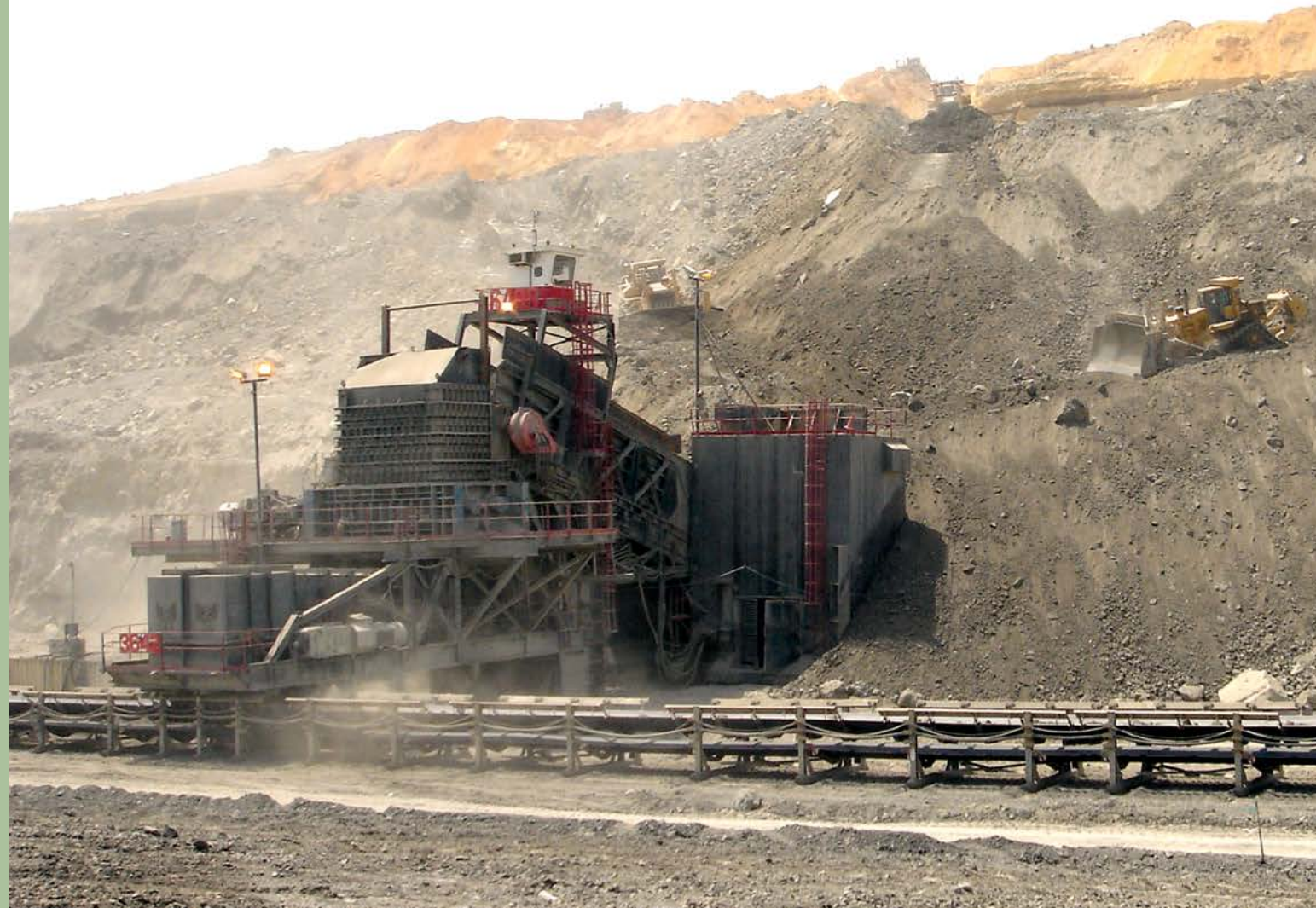
Вскрыша | Колумбия | Вход: ROM | Выход: -450мм | Производительность: 20000Тонн/час
