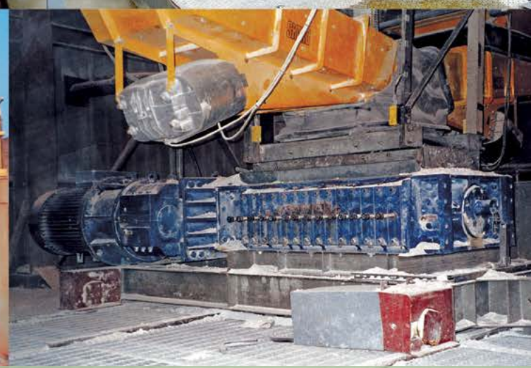
Негашеная известь | Англия | Вход: 125мм | Выход: -40мм | Производительность: 100Тонн/час
