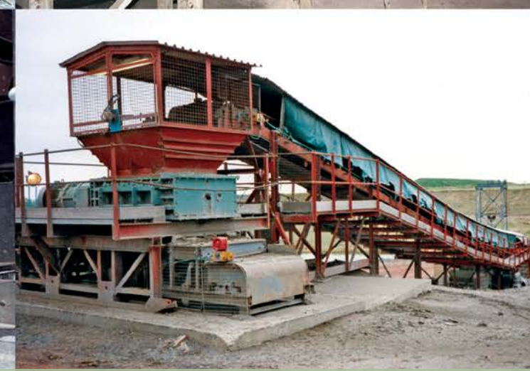
Глина | Англия | Вход: 250мм | Выход: -100мм | Производительность: 600Тонн/час
