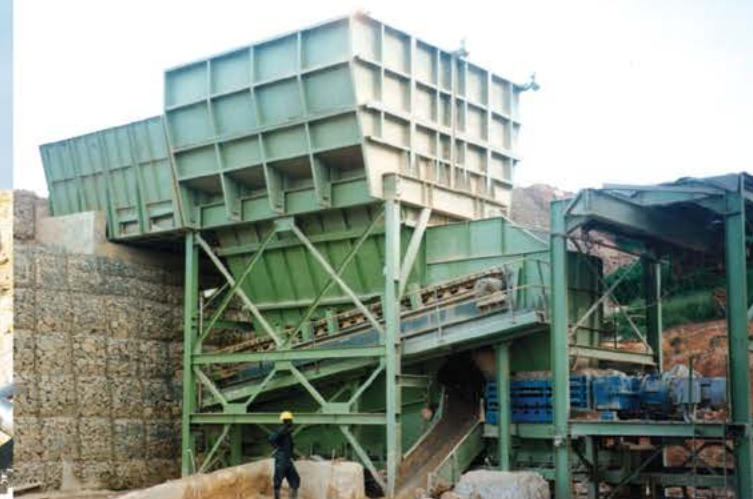
Кварцит | Гана | Вход: 500мм | Выход: -100мм | Производительность: 300Тонн/час
