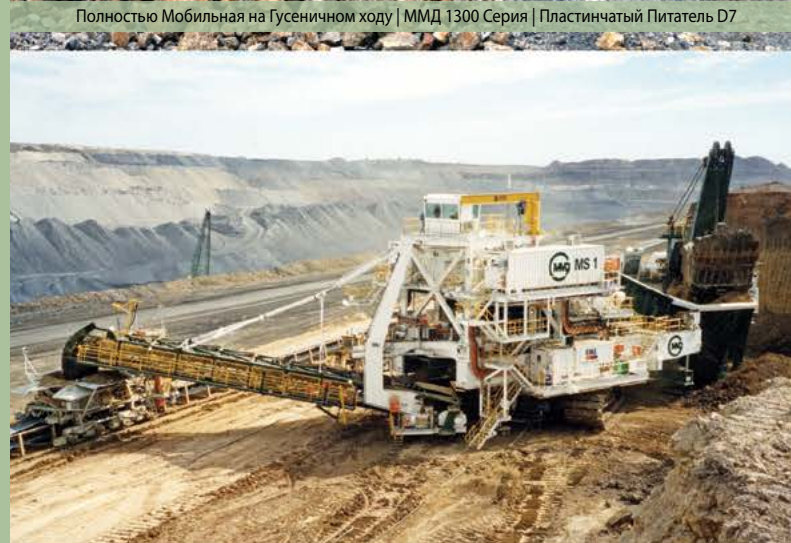
Полностью Мобильная вращающаяся Станция MS1 | Дробилка Серии 1400 | Пластинчатый Питатель D9
