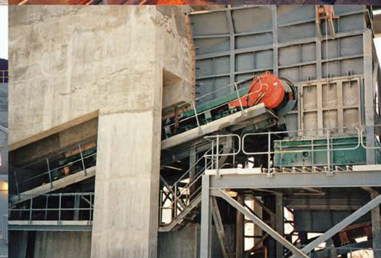
Известняк | Ливия | Вход: 1000мм | Выход: -300мм | Производительность: 1200Тонн/час
