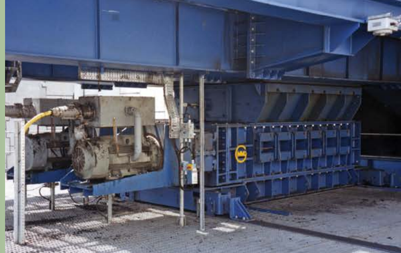
Уголь | Колумбия | Вход: 300мм | Выход: -50мм | Производительность: 1600Тонн/час
