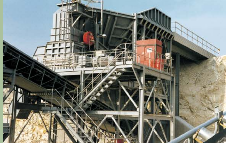
Известняк | Дания | Вход: 800мм | Выход: -150мм | Производительность: 450Тонн/час
