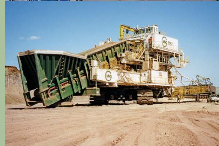
Пластинчатый Питатель D9, являющийся составной частью Мобильной Дробильной Станции
