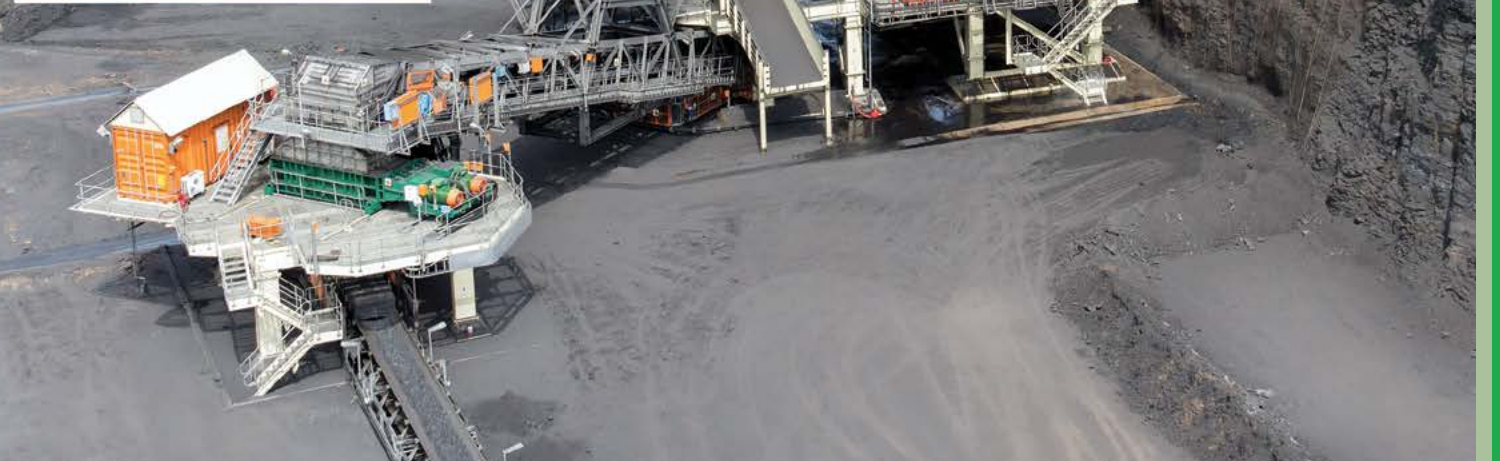
Полу-мобильная станция селективного дробления (Sizer) с одним помостом
