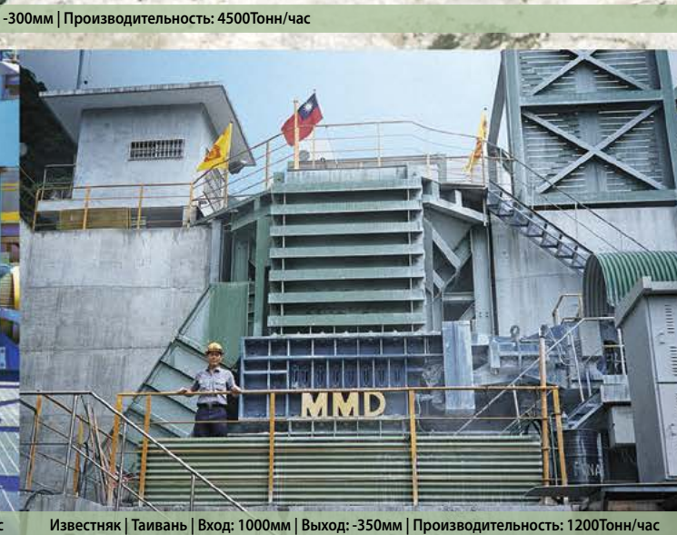
Известняк | Тайвань | Вход: 1000мм | Выход: -350мм | Производительность: 1200Тонн/час
