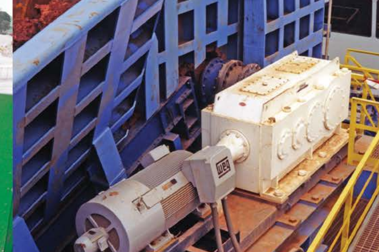
Пластинчатый Питатель D7 с электромеханическим приводом
