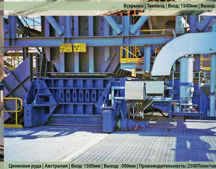
Цинковая руда | Австралия | Вход: 1500мм | Выход: -300мм | Производительность: 2500Тонн/час
