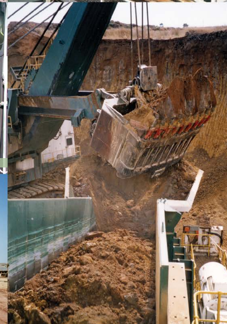
Пластинчатый Питатель D9 с электромеханическим приводом
