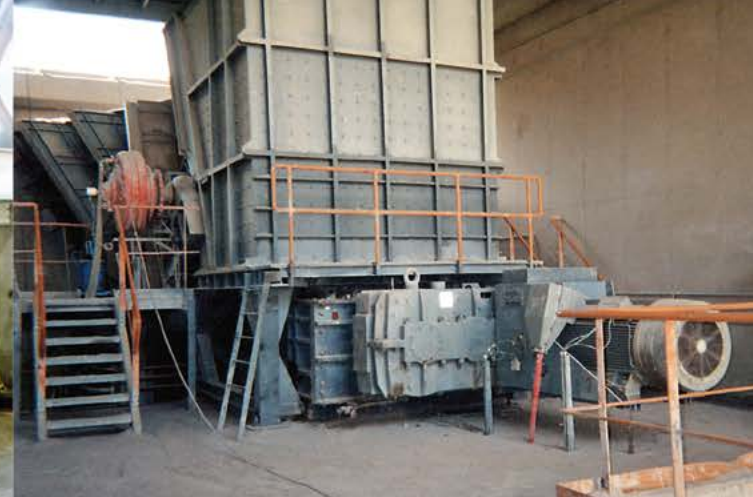
Известняк | Ливан | Вход: 800мм | Выход: -300мм | Производительность: 1500Тонн/час
