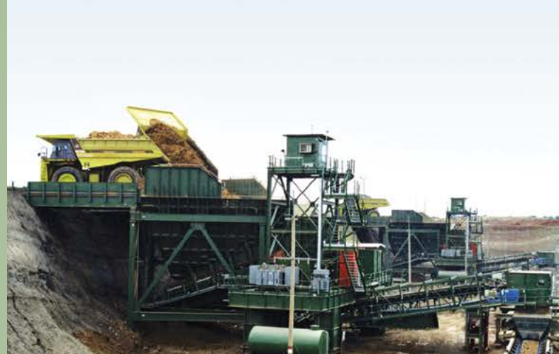
Вскрыша | Таиланд | Вход: 1200мм | Выход: -400мм | Производительность: 6500Тонн/час
