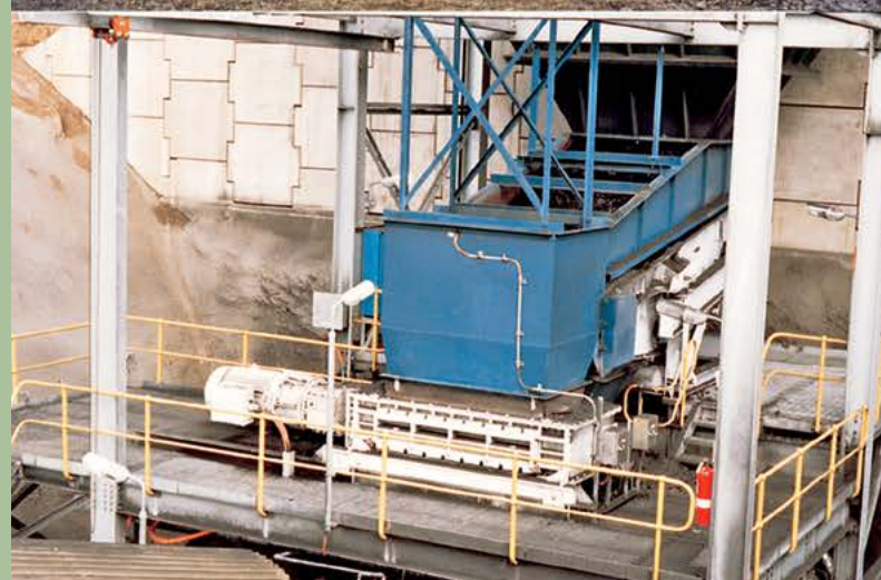
Уголь | Австралия | Вход: 400мм | Выход: -150мм | Производительность: 1300Тонн/час
