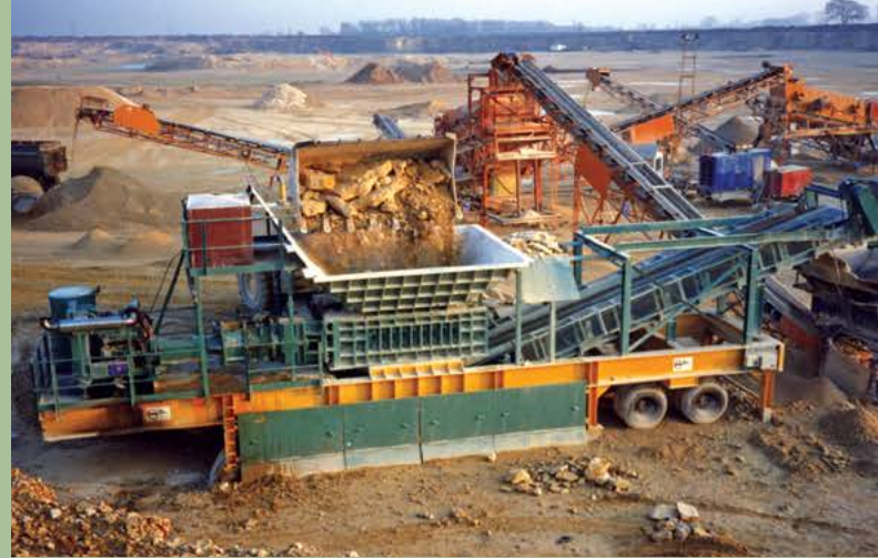
Полу-мобильная установка - Прицеп на колесной базе | ММД 750 Серии
