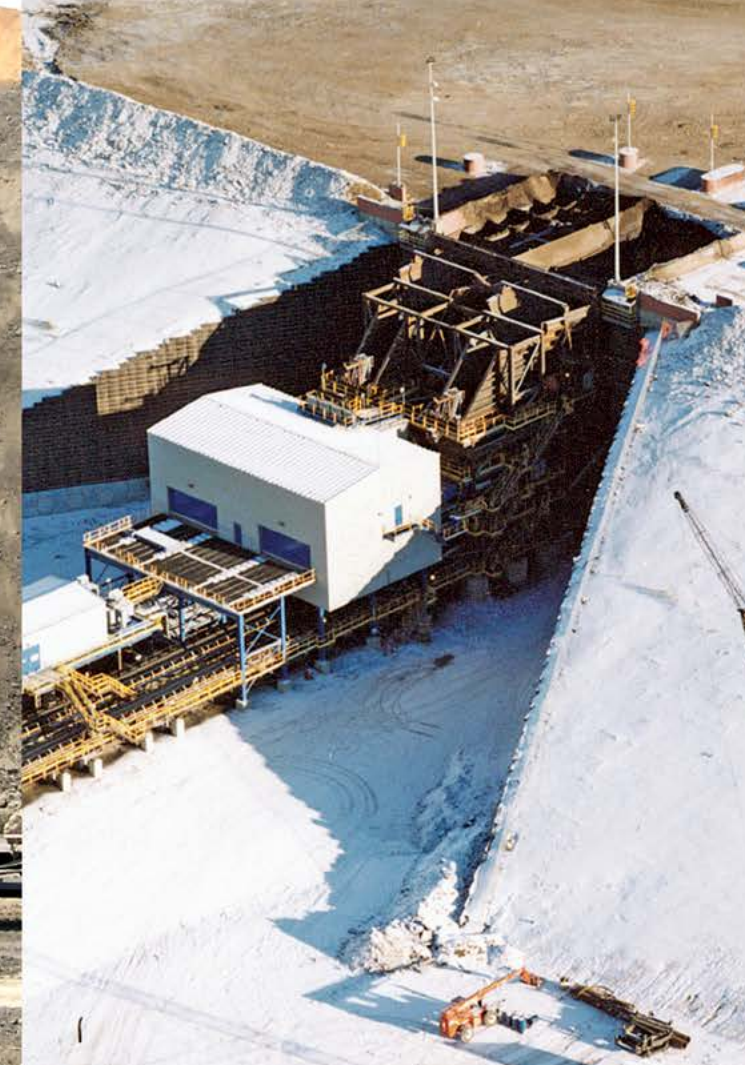
Нефтяной песок | Канада | Вход: 3000 | Выход: -400мм | Производительность: 8000Тонн/час
