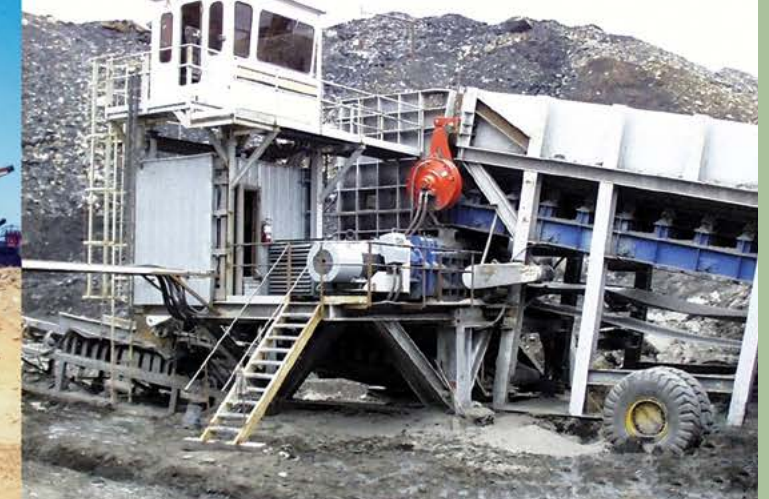
Вскрыша | Канада | Вход: 1500мм | Выход: -250мм | Производительность: 2000Тонн/час
