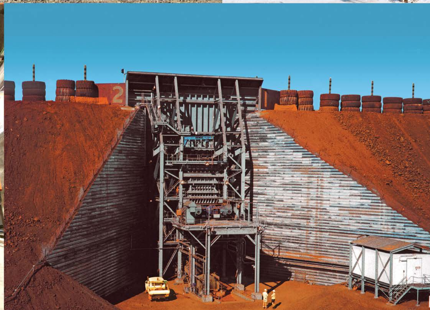
Железная руда | Австралия | Вход: 2500мм | Выход: -250мм | Производительность: 6000Тонн/час
