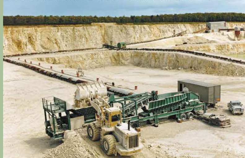
Мел | УК | Вход: 500мм | Выход: -300мм | Производительность: 600Тонн/час
