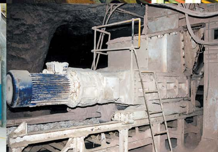
Гипс | Англия | Вход: 150мм | Выход: -40мм | Производительность: 300Тонн/час
