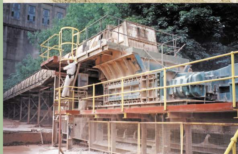
Известняк / Глина | УК | Вход: 350мм | Выход: -100мм | Производительность: 1000Тонн/час
