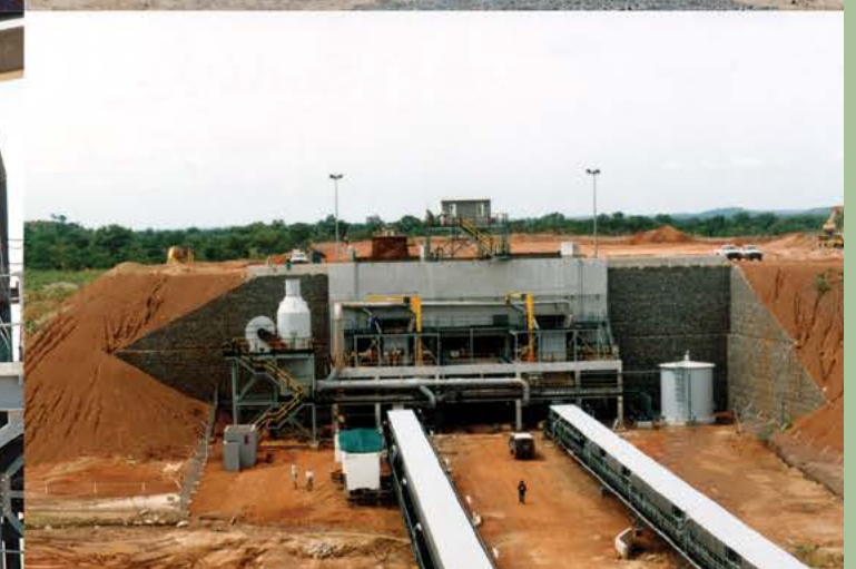
Латеритовая золотоносная руда /Глина | Мали | Вход: 1000мм | Выход: -250мм | Производительность: 750Тонн/час
