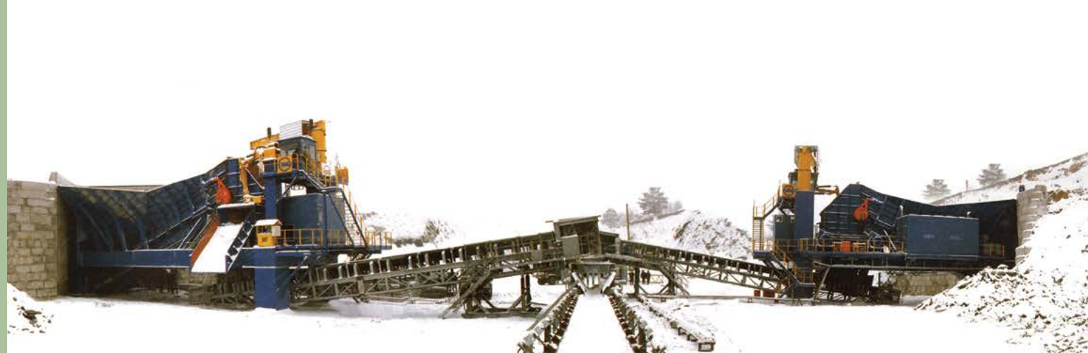
Вскрыша | Россия | Вход: 1200мм | Выход: -350мм | Производительность: 3500Тонн/час
