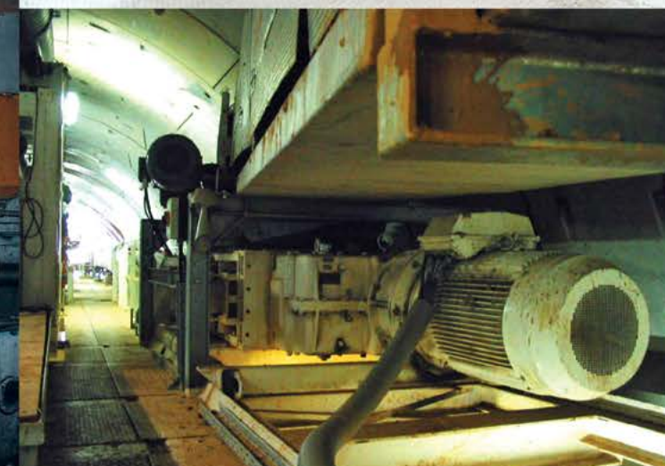
Туннельная глина/известняк | Греция | Вход: 350мм | Выход: -200мм | Производительность: 650Тонн/час
