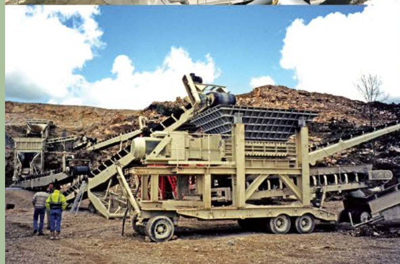
Агрегаты | Франция | Вход: 250мм | Выход: -100мм | Производительность: 600Тонн/час
