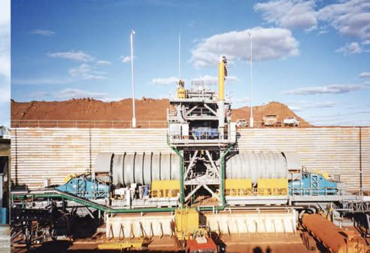
Железная руда | Австралия | Вход: 1200мм | Выход: -250мм | Производительность: 1200Тонн/час
