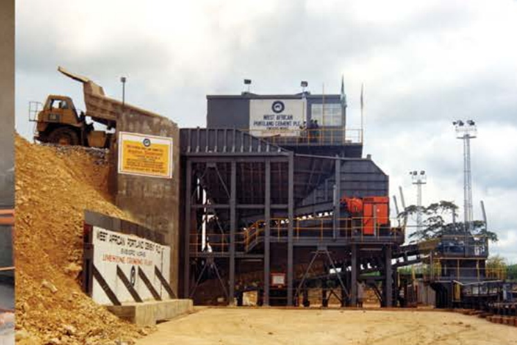
Известняк | Нигерия | Вход: 1000мм | Выход: -200мм | Производительность: 400Тонн/час
