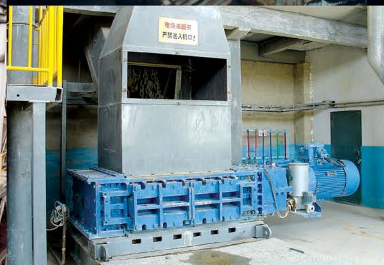
Известняк | Китай | Вход: 300мм | Выход: -80мм | Производительность: 250Тонн/час
