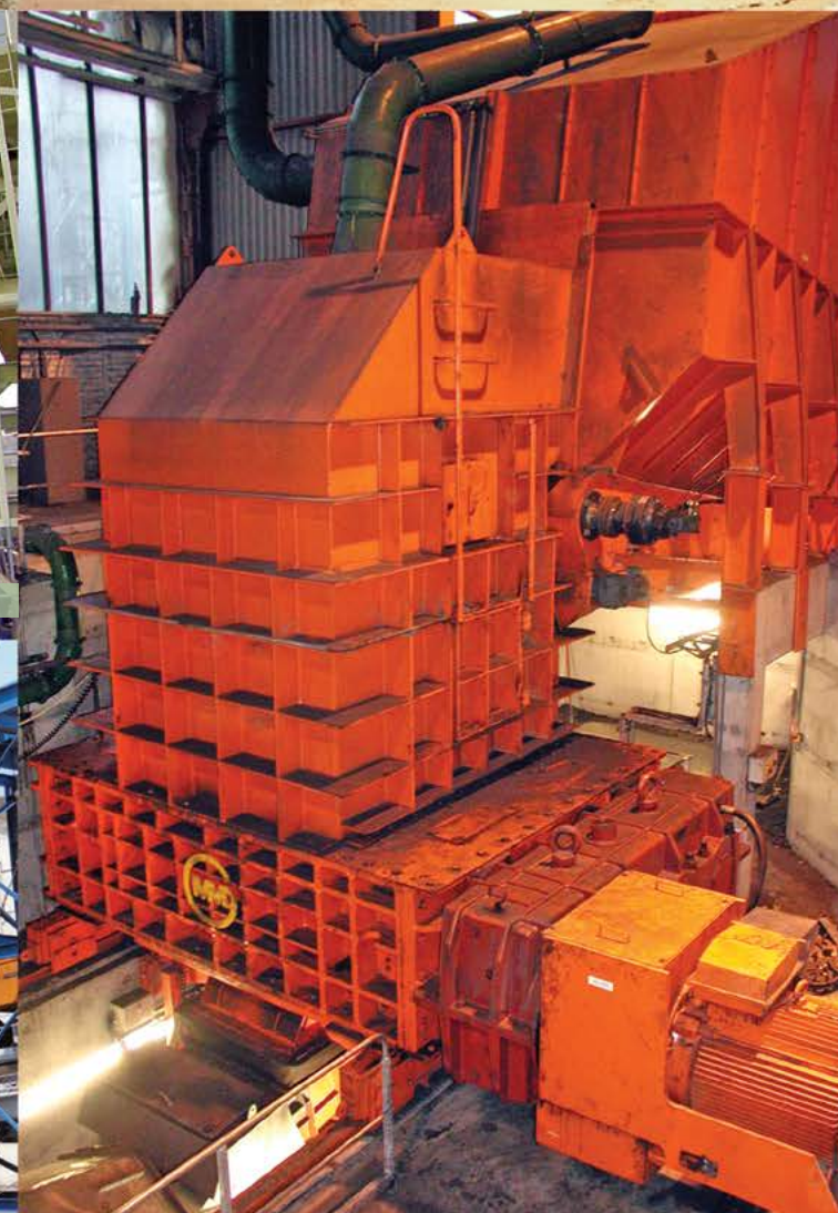
Углеродные Аноды | Норвегия | Вход: 1600мм | Выход: -350мм | Производительность: 70Тонн/час
