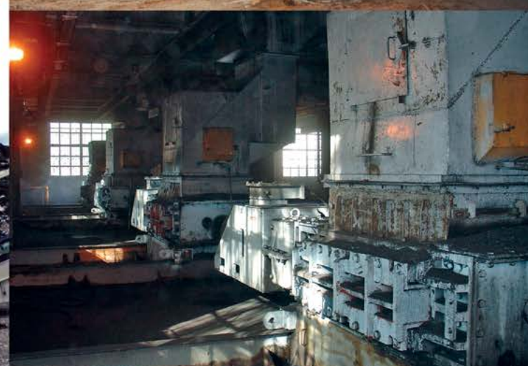
Уголь | Китай | Вход: 500мм | Выход: -50мм | Производительность: 300Тонн/час
