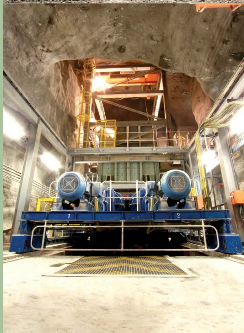
Кимберлит | Южная Африка | Вход: 2000мм | Выход: -300мм | Производительность: 800Тонн/час
