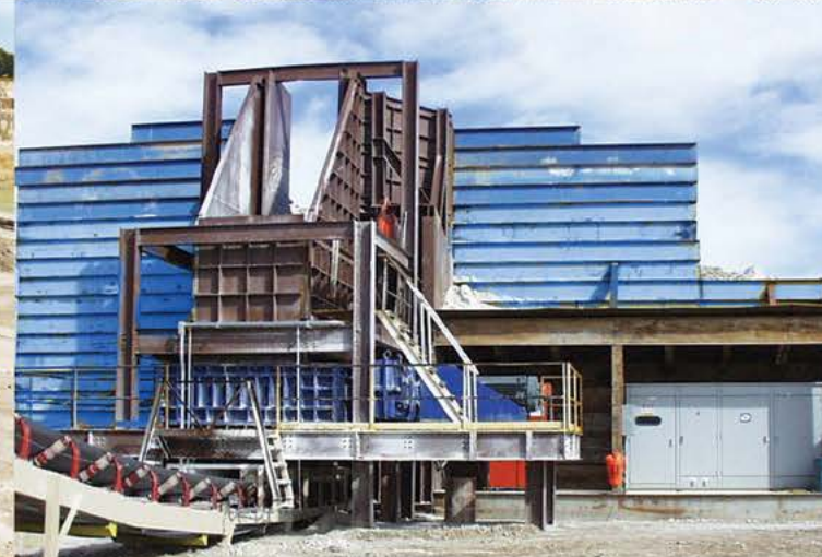
Гипс | USA | Вход: ROM | Выход: -250мм | Производительность: 1000Тонн/час
